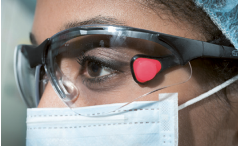
Figure 16 Les dosimètres du cristallin mesurent au mieux l'exposition lorsqu'ils sont portés sous les lunettes de protection au niveau de l'œil le plus exposé (source: IRSN_Fiche_dosimetre_Cristallin.pdf )
