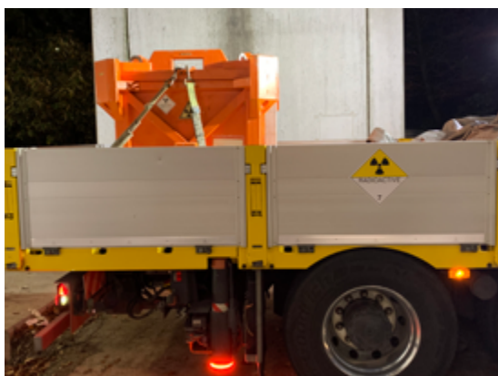
Figure 10 Les sources de haute activité issues des appareils d'irradiation du sang éliminés sont exportées dans des véhicules de transport de matières dangereuses vers des pays européens pour y être recyclées.
