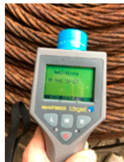
Figure 12 Détection de la source de césium-137 sur le câble du téléphérique
