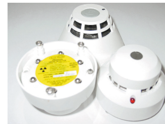
Figure 6 : Détecteur de fumée à ionisation : systèmes d'alarme incendie devant être remplacés
