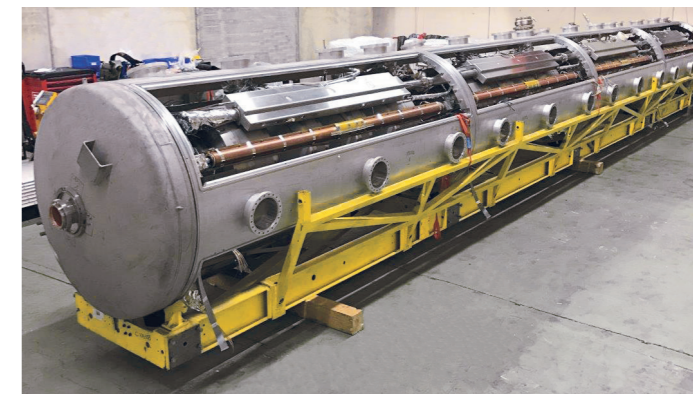
Figure 7 : Exemple de module LEP partiellement démonté contenant quatre cavités supraconductrices (photo : CERN)
