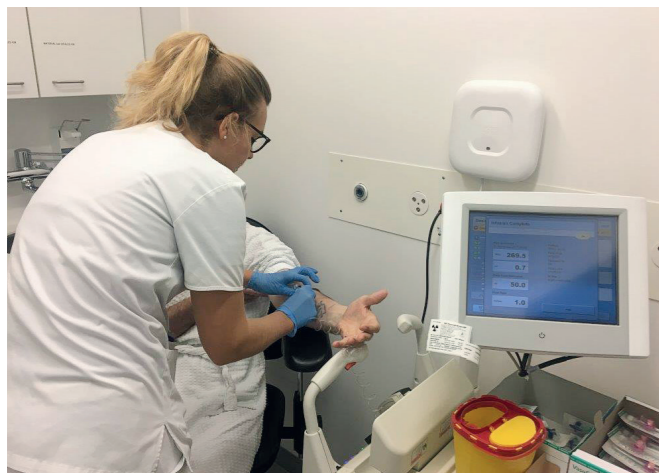
Figure 6: Chaque dose destinée à un patient en médecine nucléaire est mesurée au moyen d'un activimètre (= appareil de mesure de l'activité) avant administration
