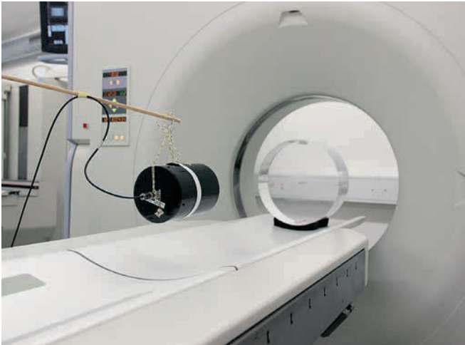
Figure 3: mesures de débit de dose ambiant sur un Scanner
