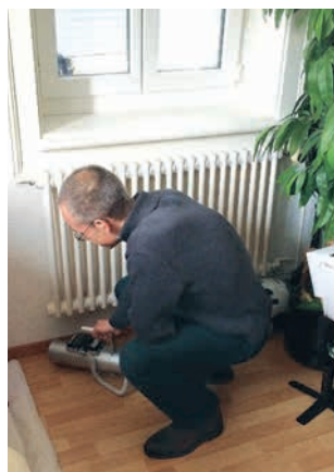
Figure 11 : mesure du débit de dose
