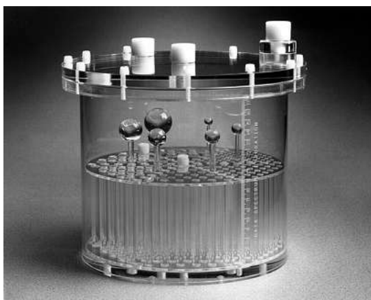
Fig. 4 : Fantôme Jaszczak utilisé pour le contrôle de la qualité d'image des caméras TEP et SPECT
