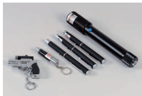
Figure 17 : Les petits pointeurs sont dotés d'un laser de classe 3B. Le plus grand est muni d'un laser de classe 4 (puissance 700 mW, infrarouge).
