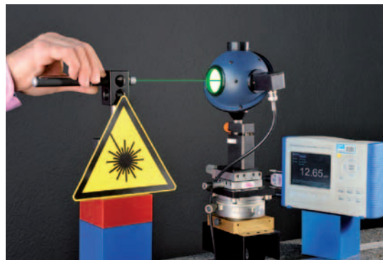
Figure 18 : Mesure d'un pointeur laser dans le laboratoire d'optique de METAS. Images : Hans Lehmann (METAS)
