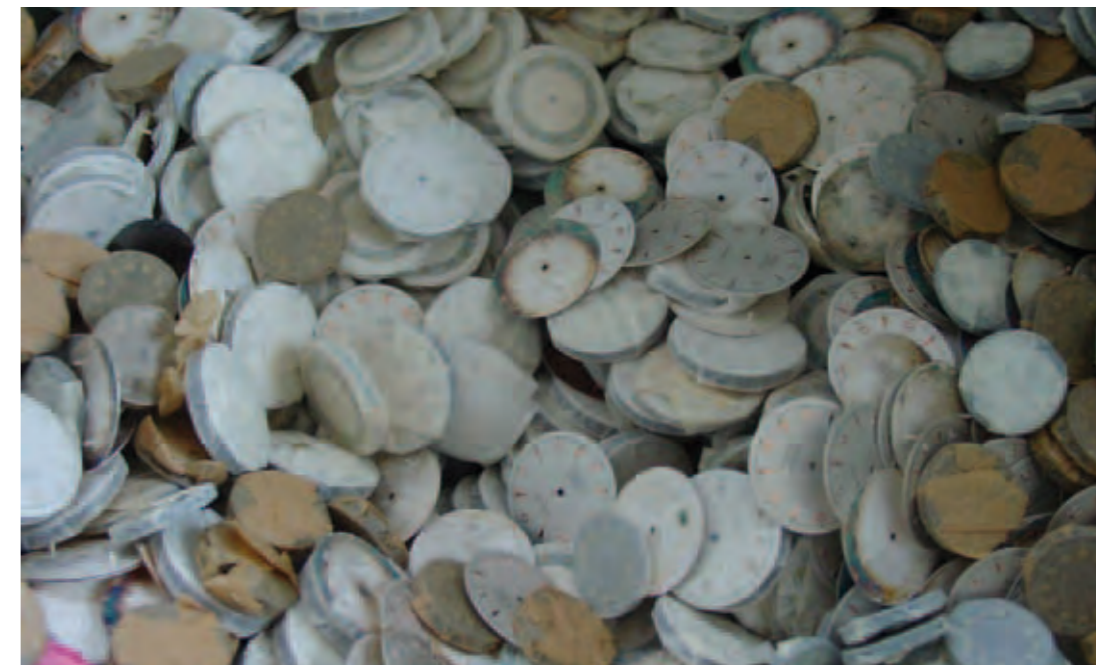
Figure 1 : cadrans de montres contenant des colorants fluorescents à base de Ra-226 et de tritium
