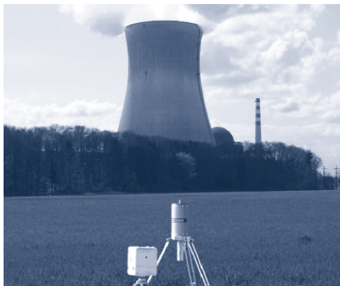
Figure 6 : Mesures in situ de la radioactivité par spectrométrie gamma
