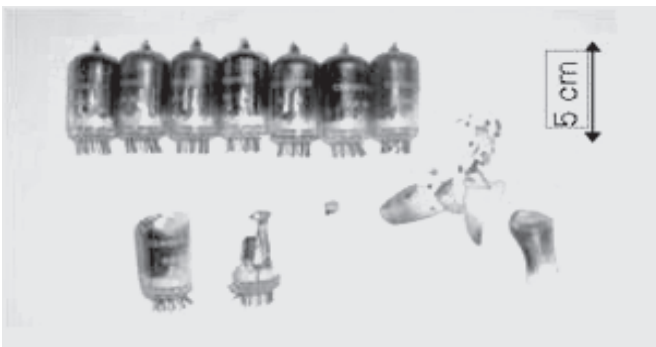
Fig. 2: Tubes électroniques contenant du ^{226}\text{Ra}
