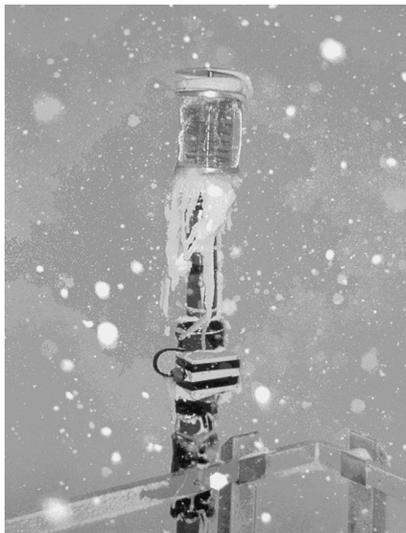
tion d'un bouchon de glace dans la ligne d'aspiration, la pompe a aspiré l'air de l'intérieur du bâtiment au lieu de l'air extérieur. La radioactivité naturelle mesurée est ainsi montée jusqu'à 140 Bq/m<sup>3</sup> alors que les concentrations extérieures sont habituellement proches de zéro.
