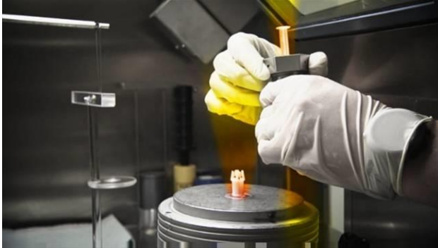
Fig. 14 : Prélèvement de l'activité à partir du récipient de stockage de F-18
