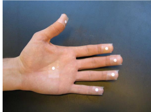
Fig. 2 : Mesure par TLD au bout des doigts et à la paume
