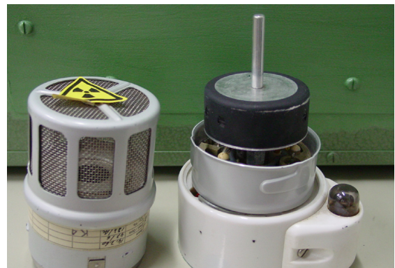
Fig. 2: Détecteur de fumée à ionisation contenant de l'Am-241
