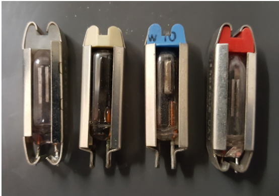
Fig. 11: Vue d'ensemble des parafoudres avec Ra-226 de l'entreprise Cerberus
