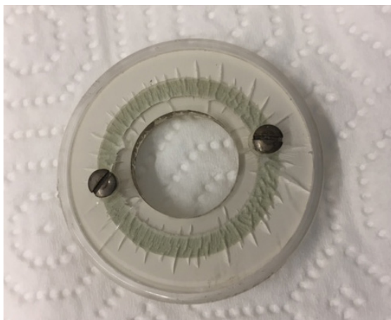
Fig. 7: Interrupteur avec peinture luminescente au Ra-226
