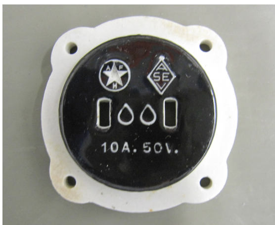
Fig. 8: Prise de courant basse tension avec peinture luminescente au Ra-226
