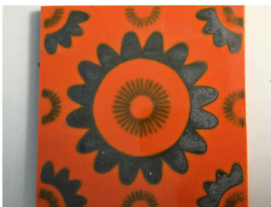
Fig. 3: Carreau de céramique orange des années 1970 contenant de l'uranium
