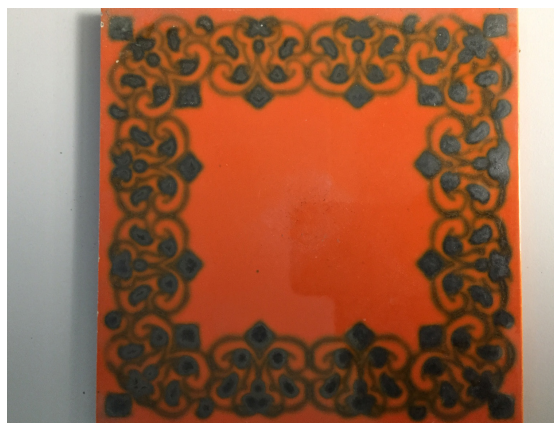
Fig. 5: Carreau de céramique orange des années 1970 contenant de l'uranium
