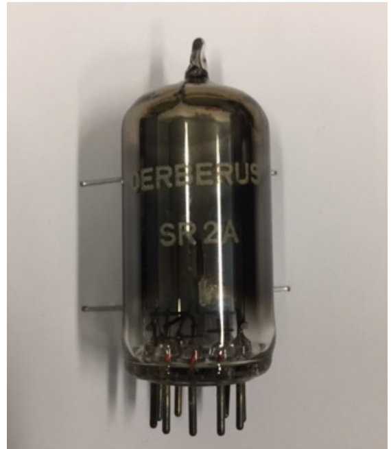
Fig. 13: Tube électronique avec Ra-226, modèle SR2A de l'entreprise Cerberus
