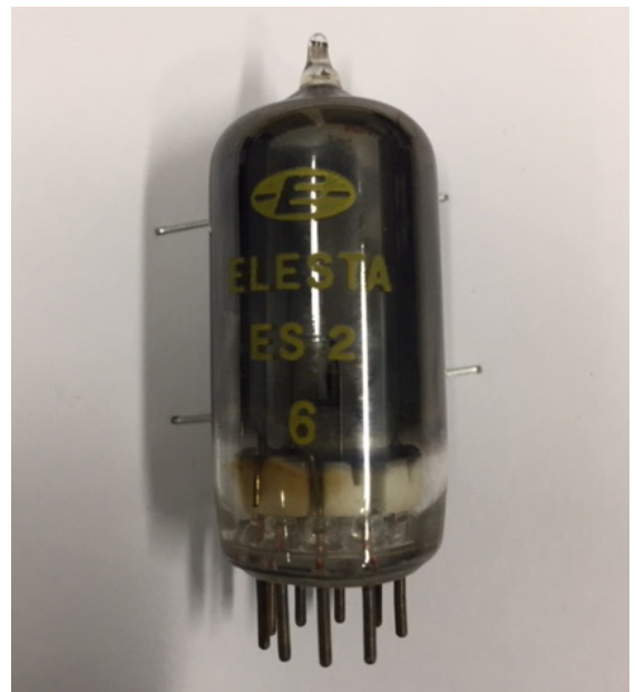
Fig. 14: Tube électronique avec Ra-226, modèle ES2 de l'entreprise Elesta
