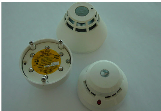
Fig. 1: Détecteur de fumée à ionisation contenant de l'Am-241
