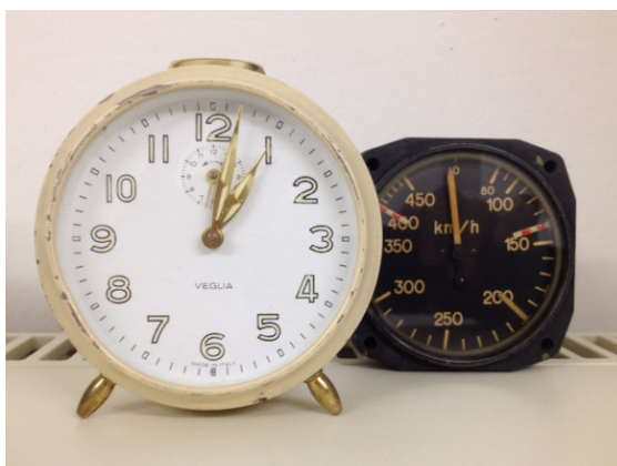
Fig. 16: Réveil et instrument de vol comportant du radium
