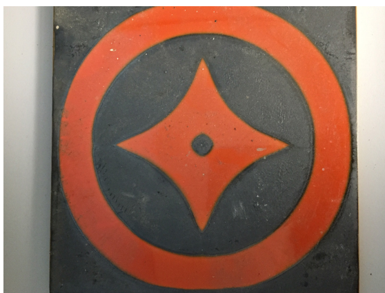
Fig. 4: Carreau de céramique orange des années 1970 contenant de l'uranium
