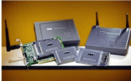
**Figure 3** Points d'accès WLAN et cartes WLAN pour PC et ordinateurs portables Fehler! Textmarke nicht definiert.
