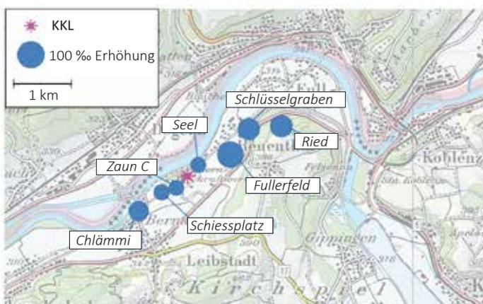
**Figur 2:** Netto  $\Delta^{14}\text{C}$ -Messwerte in der Umgebung des Siedewasserreaktors Leibstadt (KKL) im Jahr 2018. Revisionsabschaltung: 17.09.2018 bis 13.10.2018. Probenahme: 17.10.2018. Die Kreisflächen sind proportional zur Erhöhung gegenüber den unbelasteten Referenzstationen.
