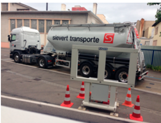
Abb.16 Messung der Radioaktivität bei der Anlieferung von Abfällen in einer KVA
