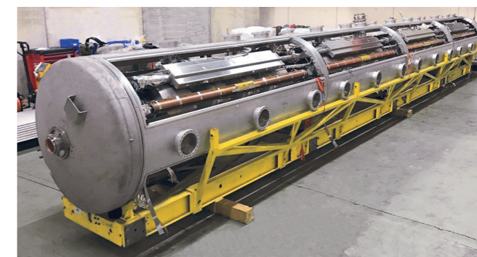
Abb. 7: Beispiel eines teilweise zerlegten LEP-Moduls mit 4 supraleitenden Kavitäten (Foto: CERN)
