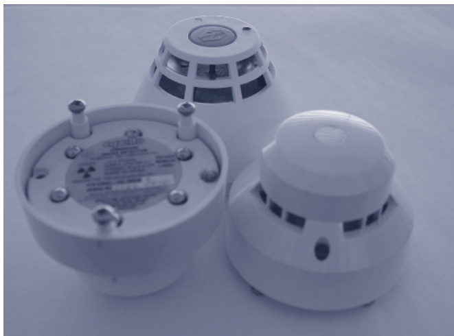
Figur 10: Feuermelder mit radioaktivem Americium-241
