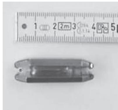
Fig. 4: Überspannungsableiter
