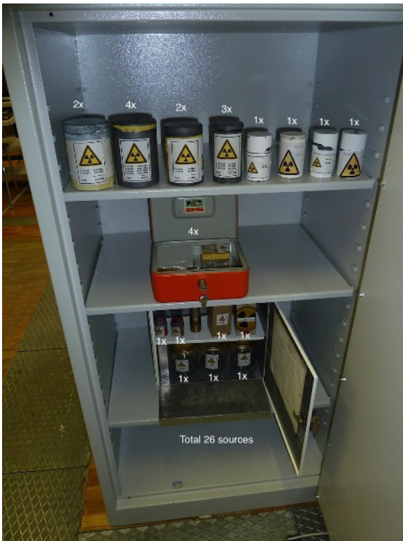
Abbildung 2: Kennzeichnung radioaktiver Quellen: Gefahrenzeichen und Informationen zum Nuklid und zur Aktivität, die eine rasche Identifikation der Quellen gewährleisten. Es muss ein System eingerichtet werden, mit dem das Fehlen einer Quelle rasch festgestellt wird.
