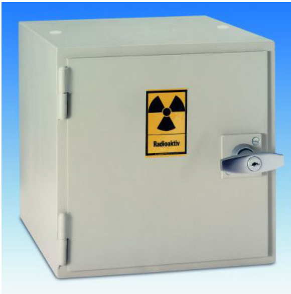
Abbildung 1: Einfacher Safe für die Lagerung radioaktiver Strahlenquellen, der den Schutz gegen Feuer und Diebstahl sicherstellt. Der Zugriff auf den Safe darf nur einer beschränkten Zahl von Personen gewährt werden. Der Safe muss mit dem Gefahrenzeichen versehen sein.
