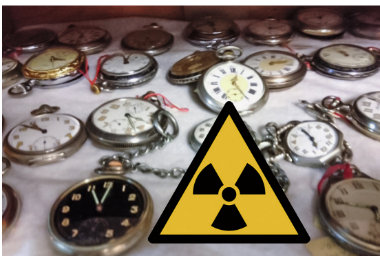
Taschenuhren mit Ra-226 Leuchtfarbe. Dosisleistung für ein Einzelstück ca. 3 Mikrosievert pro Stunde ( \mu\text{Sv/h} ) in 10 cm Abstand. Zum Vergleich: die natürliche Hintergrundstrahlung in der Schweiz beträgt etwa 0,1 bis 0,2 \mu\text{Sv/h} .
