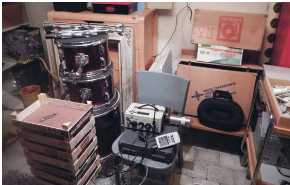
Abbildung 6.78: Radonmessung im Keller mit undichtem Boden.
