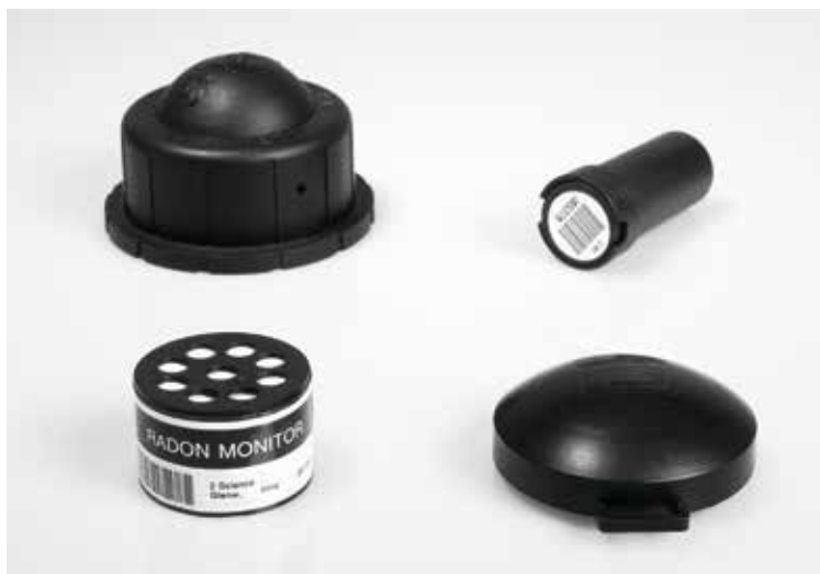
Abbildung 1.3: Radon-Dosimeter sind kleiner als ein Joghurtbecher (Quelle: BAG).
