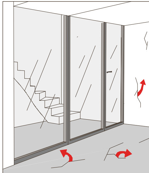
Abbildung 4.19: Raumtrennung mit Hilfe einer gasdichten Wand (Quelle: SMUL).
