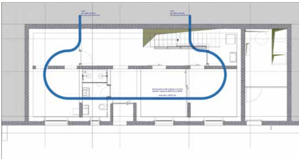
Abbildung 6.90: Plan für die Radondrainage.
