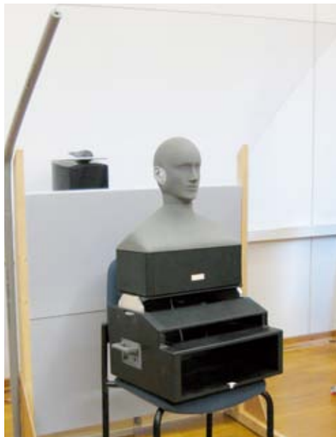
Schallschutzschirm, der in einem gemeinsamen Projekt von PTB, den Städtischen Bühnen Münster sowie der Unfallkasse NRW entwickelt wurde.
