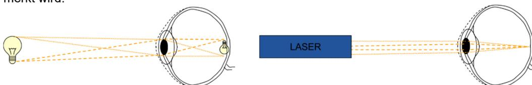
**Abbildung 4: Abbildung einer normalen Lichtquelle und eines Laserstrahls auf der Netzhaut: Die stark divergente (auf weitende) Strahlung einer Glühlampe hinterlässt auf der Netzhaut ein relativ grosses Abbild (Abbildung links). Beim Laser werden die Strahlen parallel gebündelt (kollimiert). Der Laserstrahl wird auf der Netzhaut nahezu punktförmig (10-20  $\mu\text{m}$  Durchmesser) fokussiert und hinterlässt einen Brennpunkt (Abbildung rechts). (Abbildungen vom METAS)**
