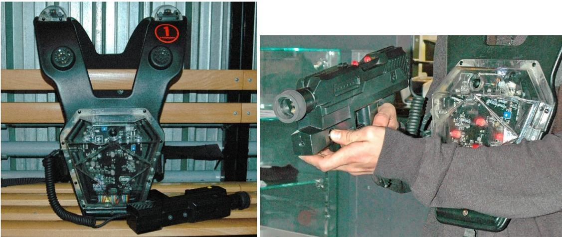
**Abbildung 1: Spielausrüstung für eine Laser Tag-Spielerin / einen Laser Tag-Spieler mit optischem Zielgerät (Tagger) (Fotos BAG)**
