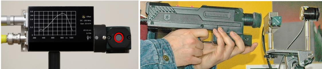
**Abbildung 2: Messempfänger mit 7 mm Öffnung um die Pupillengröße des Auges (roter Kreis) zu simulieren (links); Optische Zieleinrichtung und Messempfänger (rechts) (Fotos BAG)**
