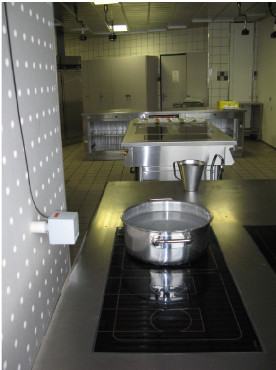
Abb. 5-1: Beispiel einer Zonenmessung, virtuelle Ebene; Bsp.: Messung an der Herdkante mit der «Standard-Pfanne» von Spring
