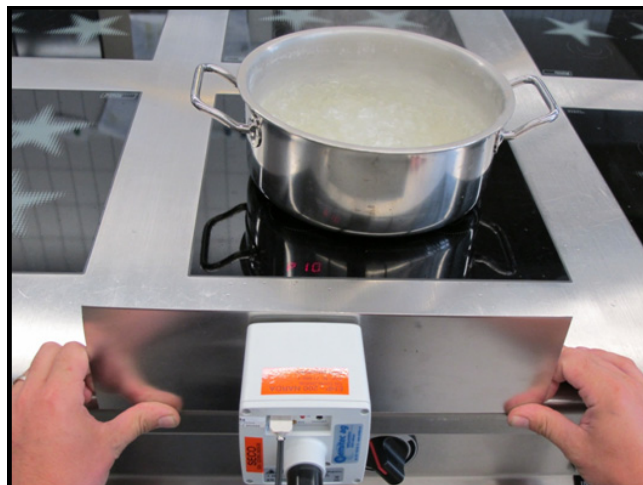
Abb. 9-2: Herd #9 mit NiFe-Blechabschirmung 110x380mm; Messung am Hotspot; die Feldstärke wird bei max. Leistungsstufe am Hotspot von 26.5 \mu T auf ca. 8 \mu T reduziert (- 30-35%).
